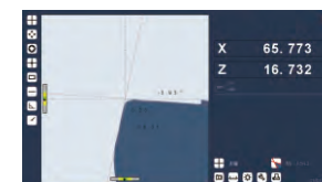
динамическое перекрестие автоматически настраивается по мере перемещения осей X и Z, а режущий инструмент может быть быстро измерен с помощью динамического перекрестия
